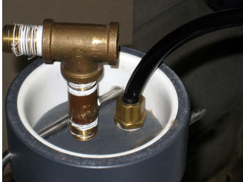
Ilustración 7.10.1-1 Extremo del tanque de presión de RO. La perforación en el centro es para el permeado y la otra para entrada de agua o salida del desecho. El conector de bronce sirve como instrumento para remover la tapa.
