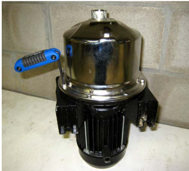
Ilustración 7.3.2-2 Ajuste del cabezal de la bomba
